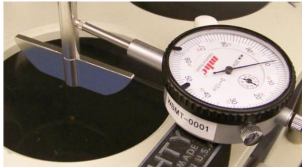
Figura 4. Comparador analógico que muestra la sonda en contacto con el eje de la paleta instalada (tener en cuenta que la medición de la oscilación de la canastilla es similar con la punta de la sonda en contacto con el borde inferior de la canastilla). Se puede usar un diseño de punta de sonda distinto, tal como una punta plana y larga.
