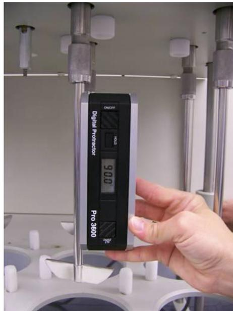
Figura 2. Medición de la verticalidad del elemento de agitación usando un transportador digital. Motor y Transmisión
