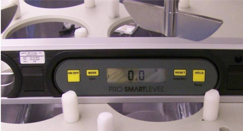
Figura 1. Nivel electrónico indicando una lectura de 0,0° en la placa base de un montaje de prueba.
